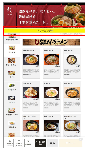
④ POSでトレーニングモードが開始されると、画面上部に黄色の帯が表示され、USEN Ticket & Payもトレーニングモードに切り替わります。
