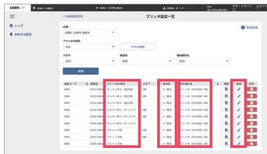
9 プリンタの役割に対してフロアごとに出力するプリンタを設定します。役割の右部にある編集用の [pen] アイコンをタップします。
