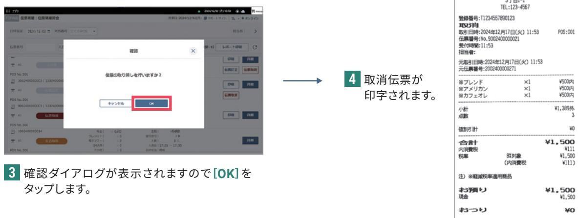
3 確認ダイアログが表示されますので [OK] をタップします。
